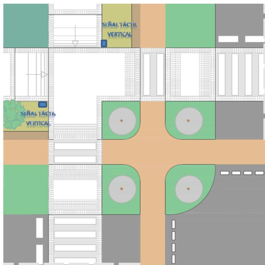
Detalle de señales táctiles horizontales en intersección a nivel de calzada, con cruce de carril bici y vehicular. La primera fila de adoquín texturizados atravesada, empieza indicando el inicio de la rampa, luego otra señal atravesada en el camino, le informa al no vidente la llegada a la esquina, en donde también el no vidente encontrará una señal
