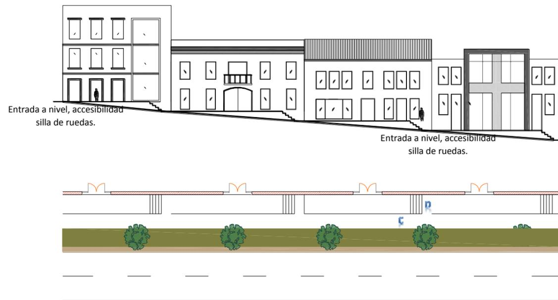
En el grafico la circulación (c) es en rampa continua. La franja de paramento(d) son plataformas para facilitar los accesos a las viviendas y locales comerciales de la planta baja, a las cuales se puede acceder por rampa cuando esta coincide con la franja de circulación de la acera, o por gradas.
